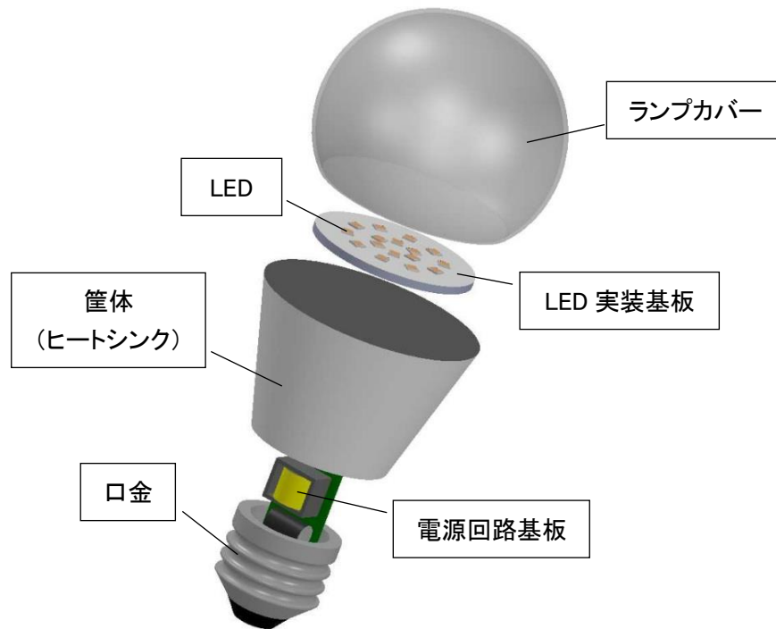
図 1. 電球形 LED ランプの構成例
